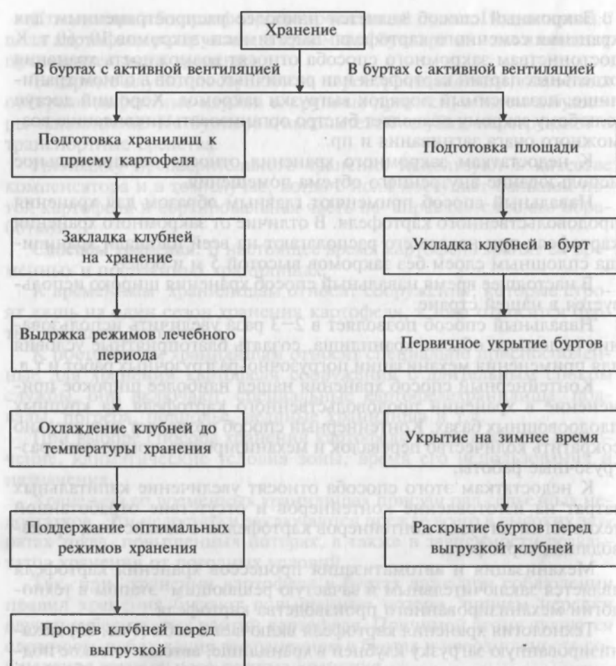
Рис. 83. Технологическая схема хранения картофеля
